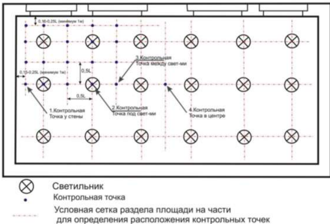
Рис. 2.2. Расположение контрольных точек при измерении минимальной освещенности помещения от светильников, принимаемых за точечные излучатели.
