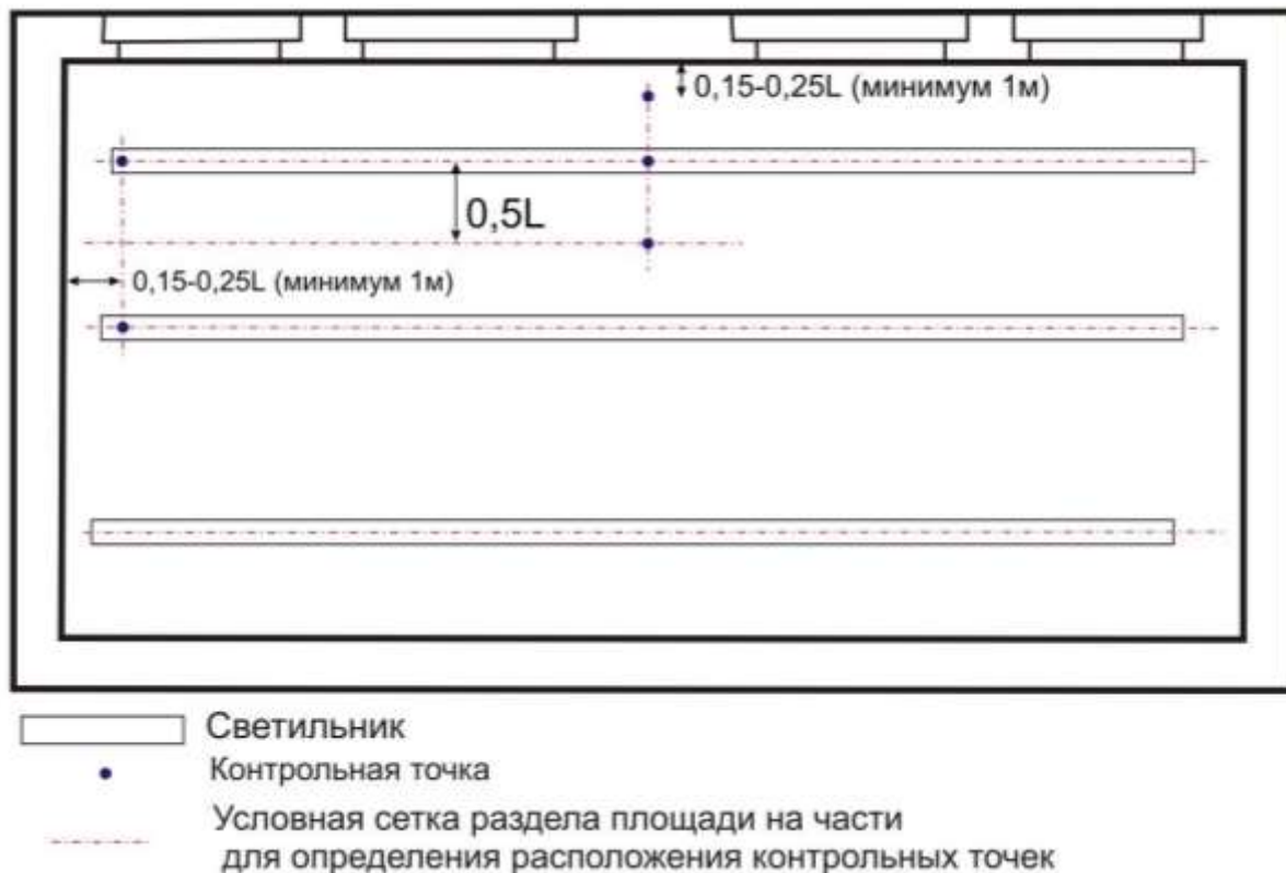
Рис. 2.3 Расположение контрольных точек при измерении минимальной освещённости помещения от светильников, принимаемых за линейные излучатели.
